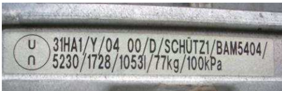
FOTO: 31HA1/Y/04 00/D/Schütz1/BAM5404/5230/1728/1053l./77 Kg./100Kpa GRG compuesto para líquidos con recipiente interior de plástico rígido y envoltura exterior de acero, para materias sólidas con llenado o vaciado por gravedad con recipiente interior de plástico rígido, para Grupos de Embalaje II y III, fabricado en abril de 2000, en Alemania (D) por Schütz1, con la contraseña BAM5404. Carga del ensayo de apilado, 5230 kg. Peso bruto máximo admisible: 1728 Kg., Capacidad 1053 litros a 20° C, Tara : 77 kg. Presión de prueba (manométrica) 100 kPa.
